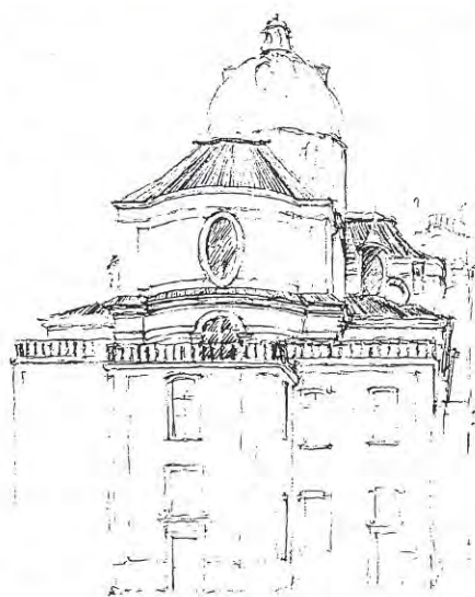
Abb. 31 Die Skizze zeigt einen denkbaren horizontalen Dachabschluß über den Choranbauten. Hinter den Brüstungen verbergen sich Graben- bzw. flache Pult- und Satteldächer.
